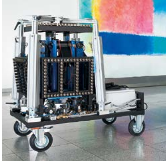
Unser patentierter Brandrauchsimulator im Transportzustand mit max. 80 cm Breite
