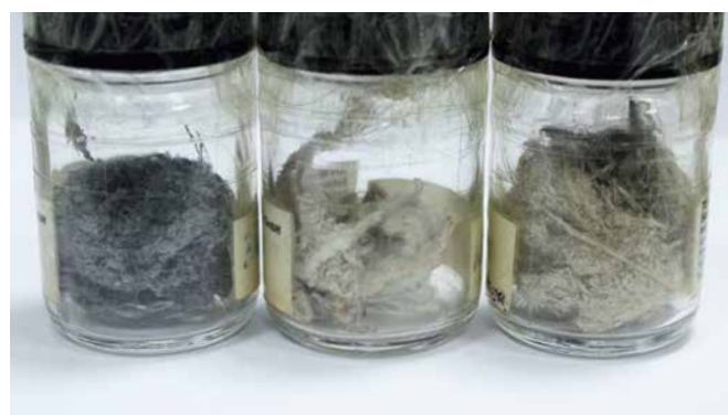
Unterschiedliche Arten von Asbest (Laborproben)
