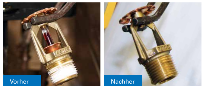
Ein Glasfasssprinkler vor und nach der Prüfung
