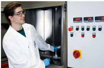
Prüfkammer und Regelung der Prüfanlage für Funktion und Wasserdurchfluss
