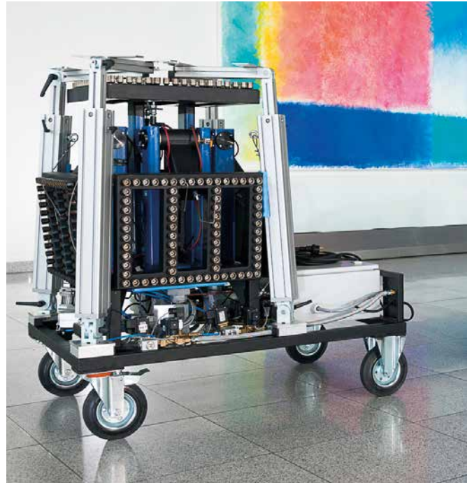
Brandrauchsimulator im Transportzustand mit max. 80 cm Breite
