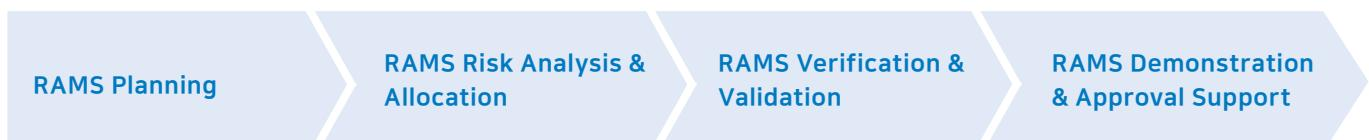
시스템 개념 단계에서 신뢰성, 가용성, 유지보수성, 안전성 목표를 정의하고 RAMS 계획 및 분석 전략을 수립합니다.
