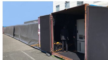
FMVSS車載用カメラセンサー試験 奥行き30メートルの暗室
