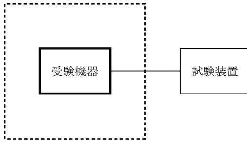
温湿度試験槽 (恒温槽)
