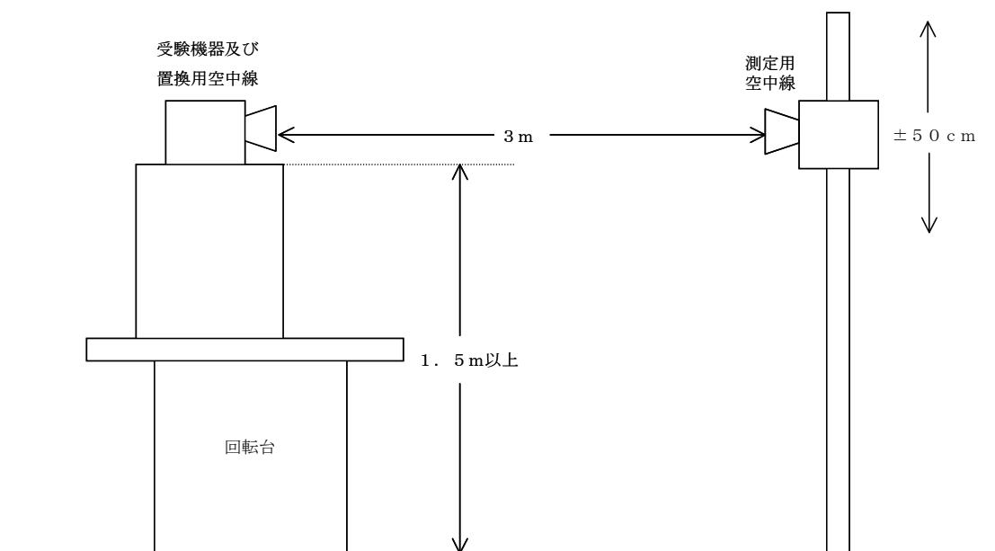
ア 受験機器及び置換用空中線は回転台上に乗せ地上高1.5m（底部）以上でできる限り高くする。台の材質及び受験機器等の設置条件は、昭和63年2月25日郵政省告示第127号「発射する電波が著しく微弱な無線局の電界強度の測定方法」（電波法施行規則（昭和25年11月30日電波監理委員会規則第14号（以下「施行規則」という。））第6条第2項関係）に準ずる。
