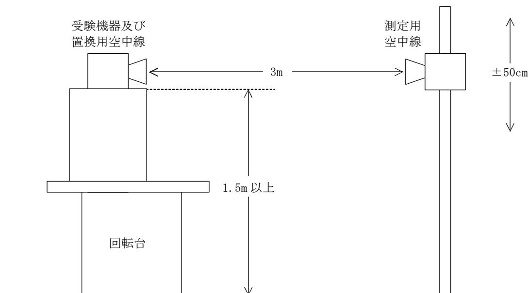
ア 受験機器及び置換用空中線は回転台上に乗せ地上高1.5m(底部)以上でできる限り高くする。台の材質及び受験機器等の設置条件は、昭和63年2月25日郵政省告示第127号「発射する電波が著しく微弱な無線局の電界強度の測定方法」施行規則第6条第2項関係)に準ずる。
