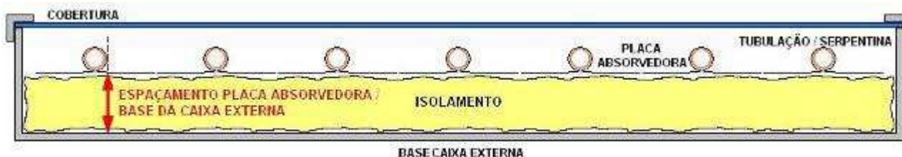
Figura 13. Medida do espaçamento entre Placa Absorvedora e Cobertura de coletores solares fechados
